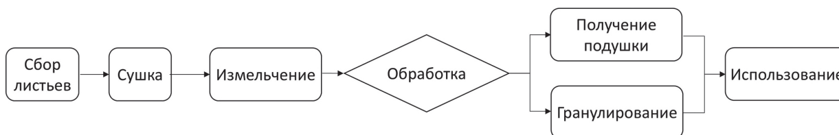
Рис. 2. Технологическая схема получения нефтесорбента из опавшей листвы
