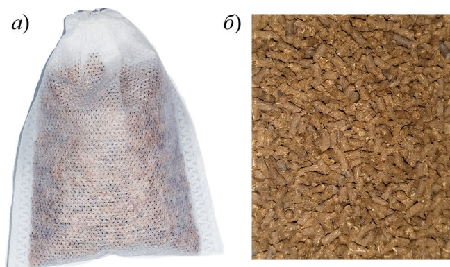
Рис. 4. Внешний вид нефтесорбента в виде подушки (а) и в виде гранул (б)
