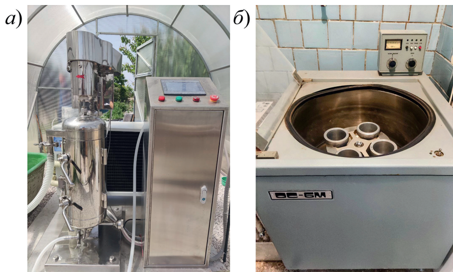
Рис. 3. Оборудование для сбора урожая микроводоросли P. purpureum : проточный сепаратор GQ-75 (Россия) (а); лабораторная центрифуга ОС-6М (Россия) (б)
